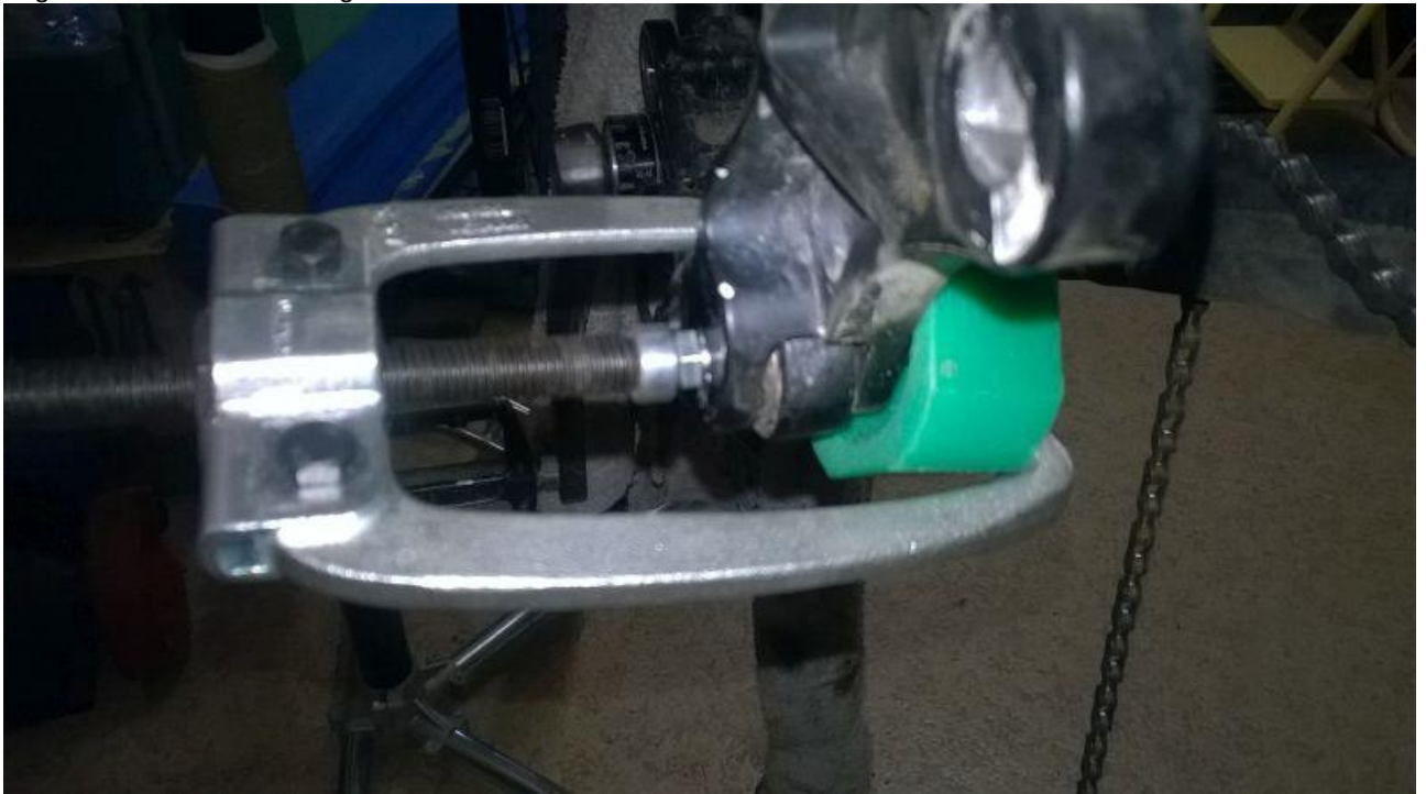
Lager-Bolzen nahezu ausgedrückt:
